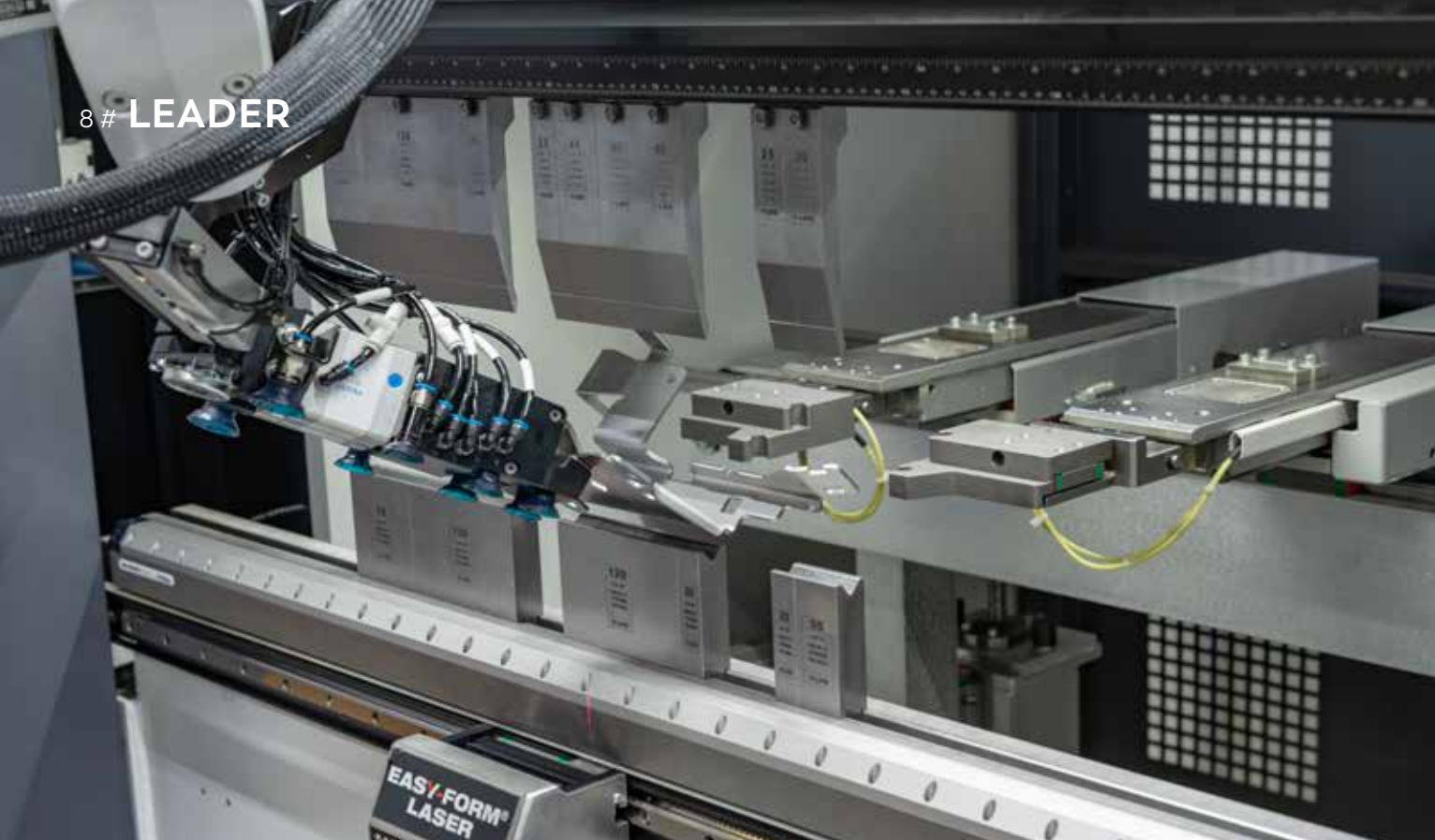
Cella di piegatura robotizzata Dyna-Cell
